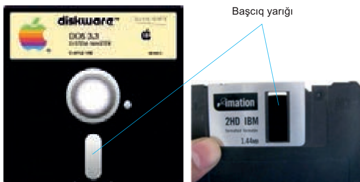
H-12. 5.25 düymlük (solda) və 3.5 düymlük (sağda) disklərdə başcıq yarıqları. 3.5 düymlük diskdə metal qapaq sürüşdürülüb ki, başcıq yarığı görünsün
