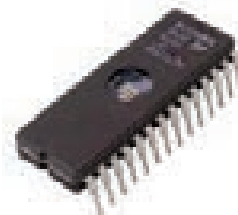
E-18. EPROM mikrosxeminin üzərindəki kiçik bacadan ultrabənövşəyi şüalandırma ilə verilənləri silmək olur.
