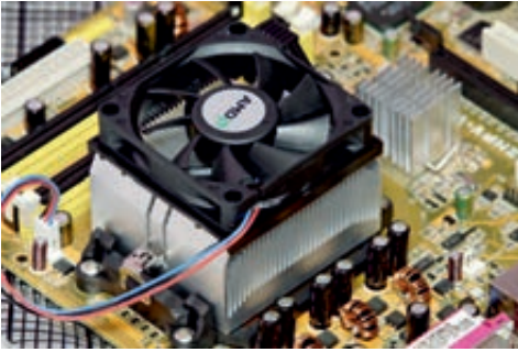
H-14. Fərdi kompüterin prosessorunun üzərində quraşdırılmış istilikudan. Ondan sağda nisbətən kiçik istilikudan başqa bir mikrosxemi soyudur.
