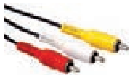
R-10. Videosiqnal (sarı) və stereofonik səs (ağ və qırmızı) üçün RCA bağlayıcıları
