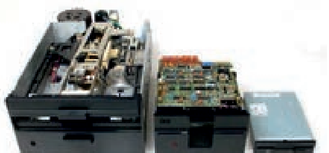
F-22. 8-düymlü, 5 1/4-düymlü və 3 1/2-düymlü əyilgən disklər üçün disksürənlər
