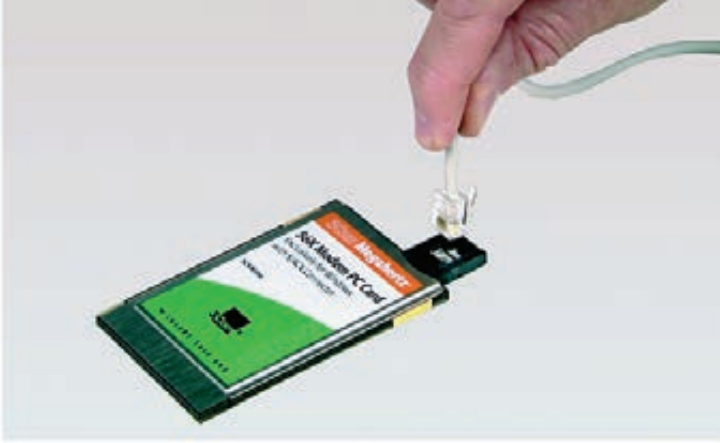
X-03. RJ11 bağlayıcısının XJACK yuvasına taxılması
