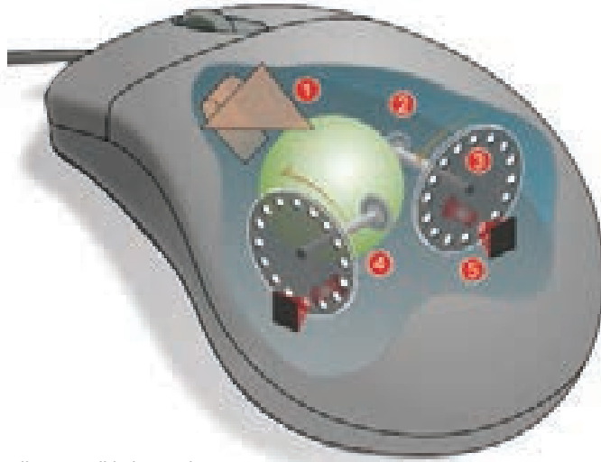
O-09. Optik-mexaniki siçanın iş mexanizmi:
