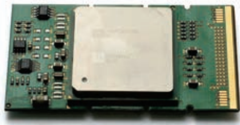
I-34. Intel Itanium 2 mikroprosessoru
