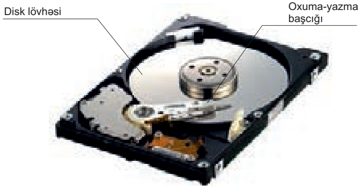
H-08. Sərt disk qurğusu (üst qapaq çıxarılıb)
