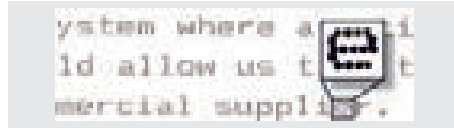
D-39. Matrisli printerdə görüntünün formalaşdırılma prinsipi
