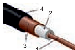
C-34. Koaksial kabelin quruluşu: 1 – mərkəzi özək (mis məftil), 2 – dielektrik izolyator (polietilen), 3 – metal ekran, 4 – plastik örtük.
