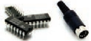
P-35. 14-iyənəli DIP mikrosxemi (solda) və 5-iyənəli DIN bağlayıcısı (sağda)
