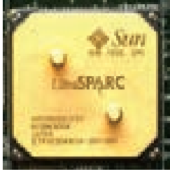
R-33. Sun UltraSPARC şirkətinin RISC mikroprosessoru
